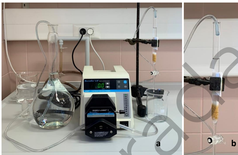
Slika 11 Prikaz (a) sustava za ispitivanje adsorpcije nitrata u koloni i (b) kolona napunjena adsorbensom
