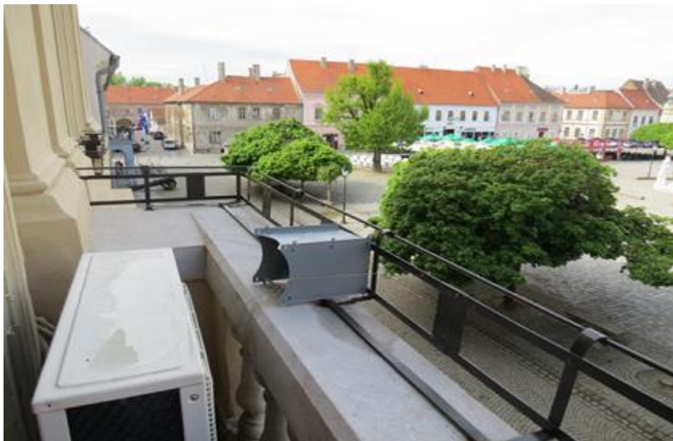
Slika 2. Pravilno postavljene uzorkivače na vanjskoj točki
