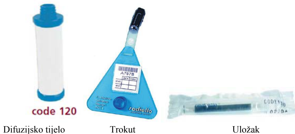
Slika 4. Dijelovi uzorkivača za benzen
