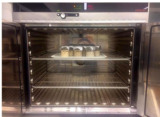
Slika 4. Toplinska predobrada lignoceluloznih supstrata u sušioniku
