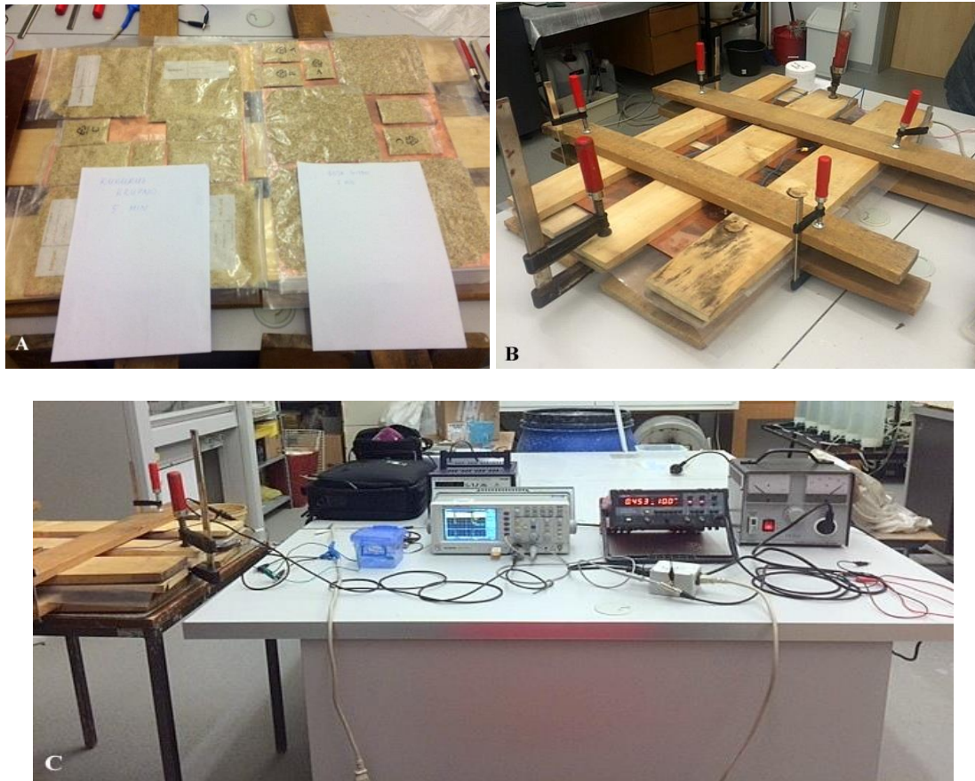
Slika 7. Predobrada lignoceluloznih supstrata električnim poljem: A) lignocelulozni supstrati u plastičnim zip vrećicama postavljenim na Cu ploče kondenzatora, B) lignocelulozni supstrati u plastičnim zip vrećicama postavljeni između Cu ploča kondenzatora pričvršćenih drvenim daskama i vijčanim stegama, C) sustav za predobradu lignoceluloznih supstrata
