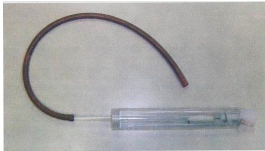
Slika 13. Aspirator za hvatanje odraslih komaraca
