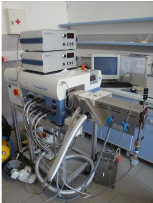
Slika 25. Laboratorijski jednopužni ekstruder Brabender 19/20 DN (Jozinović, 2015)
