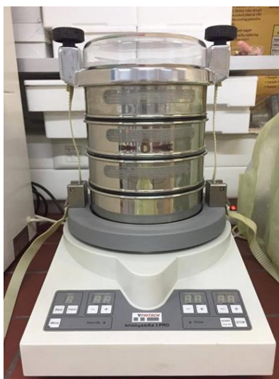
Slika 17. Laboratorijska tresilica s vibrirajućim sitima (Analysette 3 PRO, Fritsch, Njemačka)
