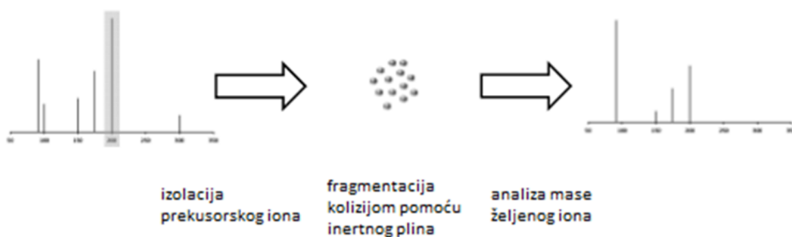
Slika 12. Shematski prikaz rada MS/MS sustava (prilagođeno iz Madeira i Florêncio, 2012)
