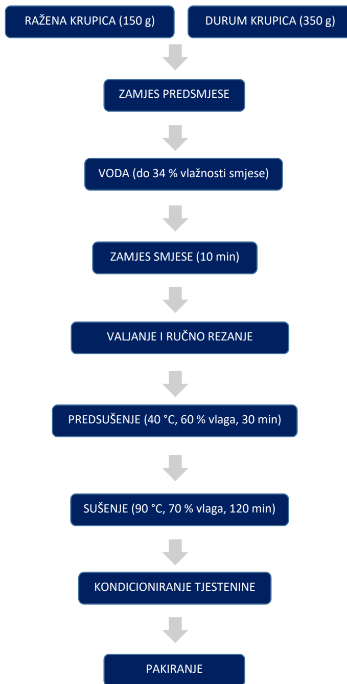
Slika 21. Shematski prikaz konvencionalne proizvodnje tjestenine
