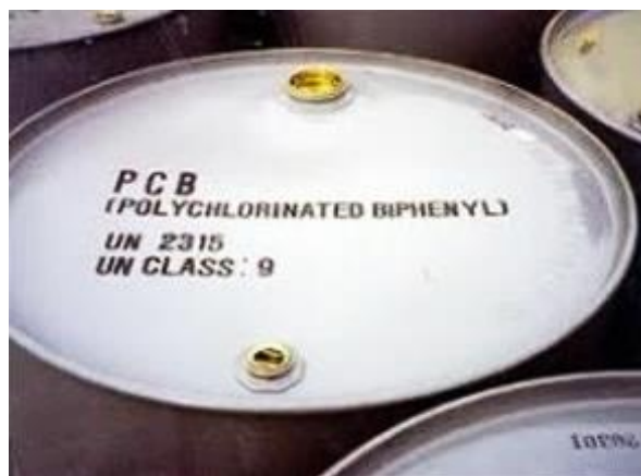
Slika 27. Skladištenje otpadnog rashladnog ulja koje sadrži PCB
