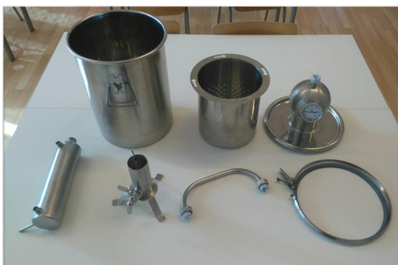
Slika 15. Shematski prikaz destilacije vodenom parom (Letina Intech d.o.o., Čakovec)
