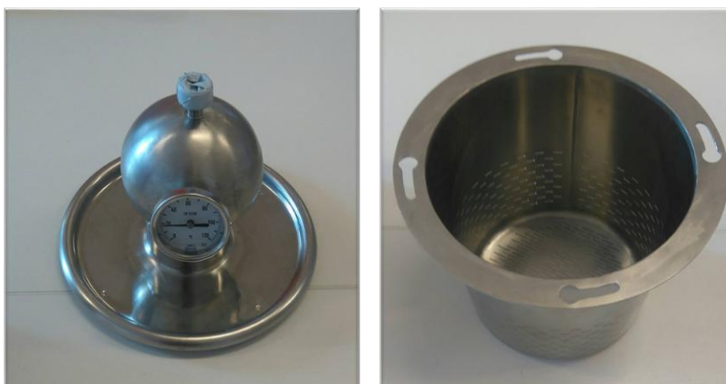
Slika 18. Poklopac s analognim termometrom (lijevo). Perforirana košara (desno), (autor: Pero Grgić)
