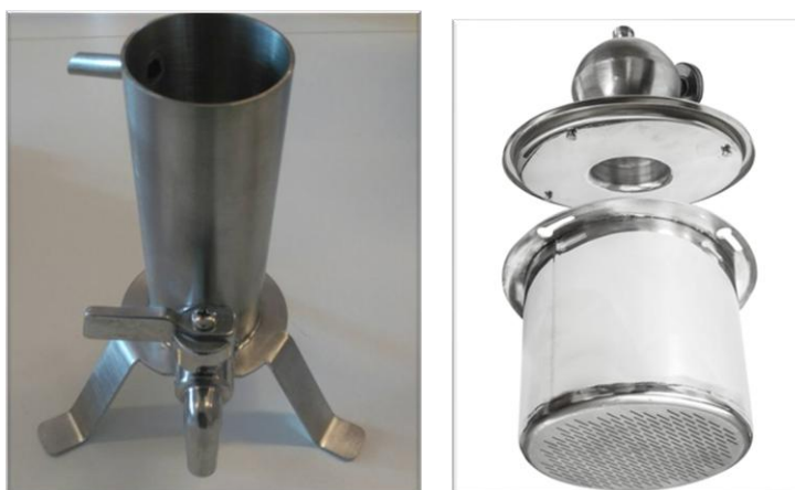
Slika 19. Separator/florentinska posuda (lijevo). Spajanje poklopca s perforiranom košarom (desno), (autor: Pero Grgić)
